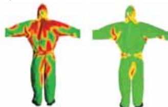
Overol de protección 4540+ de 3M™ sin panel ventilado      Overol de protección 4540+ de 3M™ con panel ventilado
